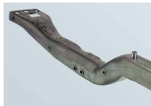
Podłużnica samochodowa wykonana metodą hydro-formowania
